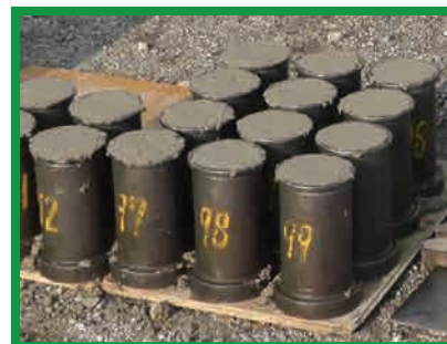
テストピースによる強度確認
